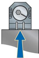
**Finecorsa semplice** (1 solo appoggio rigido). Per posizionare un pezzo in base all'asse occorrono 2 finecorsa.
