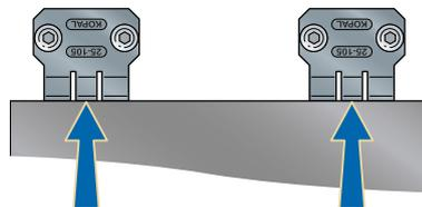
**Finecorsa doppio** (2 appoggi rigidi). Un finecorsa è sufficiente per posizionare un piccolo pezzo in base all'asse.
